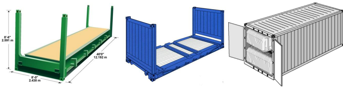
Фиг. 7. Контейнери платформи и контейнер за дрехи на закачалки (вдясно)
