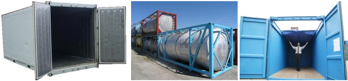
Фиг. 6. 20 футов контейнер (вляво), танк контейнер (в средата), контейнер с отвор на покрива (вдясно).
