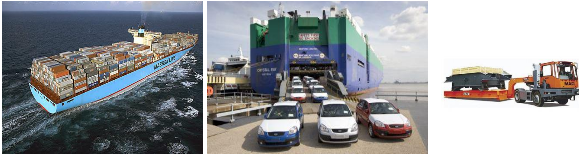
Фиг. 2. Контейнеровоз (вляво), кораб от типа РСС (в средата) и и ремарке Маfi (вдясно).
